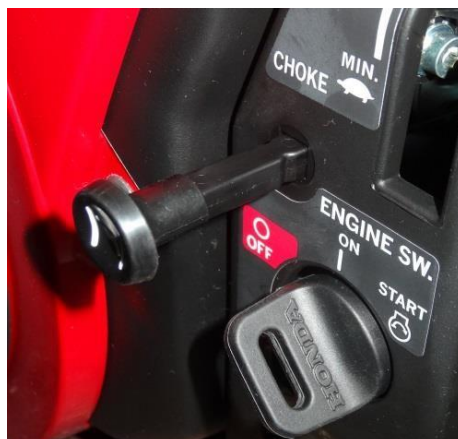
Páčka ovládání sytiče v poloze ZAPNUTO – pro modely SP10-12H, TP12-15H
