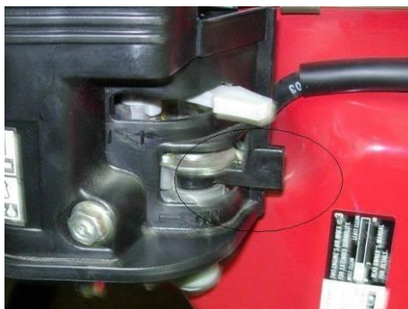
Palivový kohout v poloze ON (OTEVŘEN) – pro modely SP2-6H, TP5-7H
