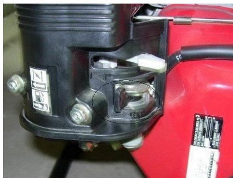
Palivový kohout v poloze OFF (UZAVŘEN) – pro modely SP2-6H, TP5-7H
